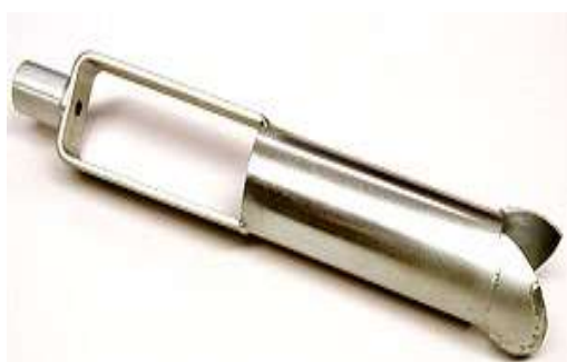
شکل ۳- مته نمونه برداری نوع مارپیچی باز شکل ۴- مته نمونه برداری نوع استوانه ای بسته
